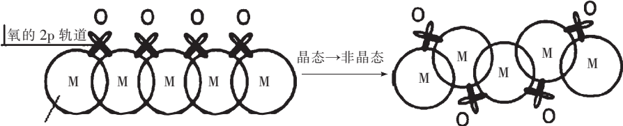
图 4 a-IGZO 的电子结构示意图(M 代表金属、O 代表氧) Fig. 4 Schematic illustration of electronic structure for a-IGZO
